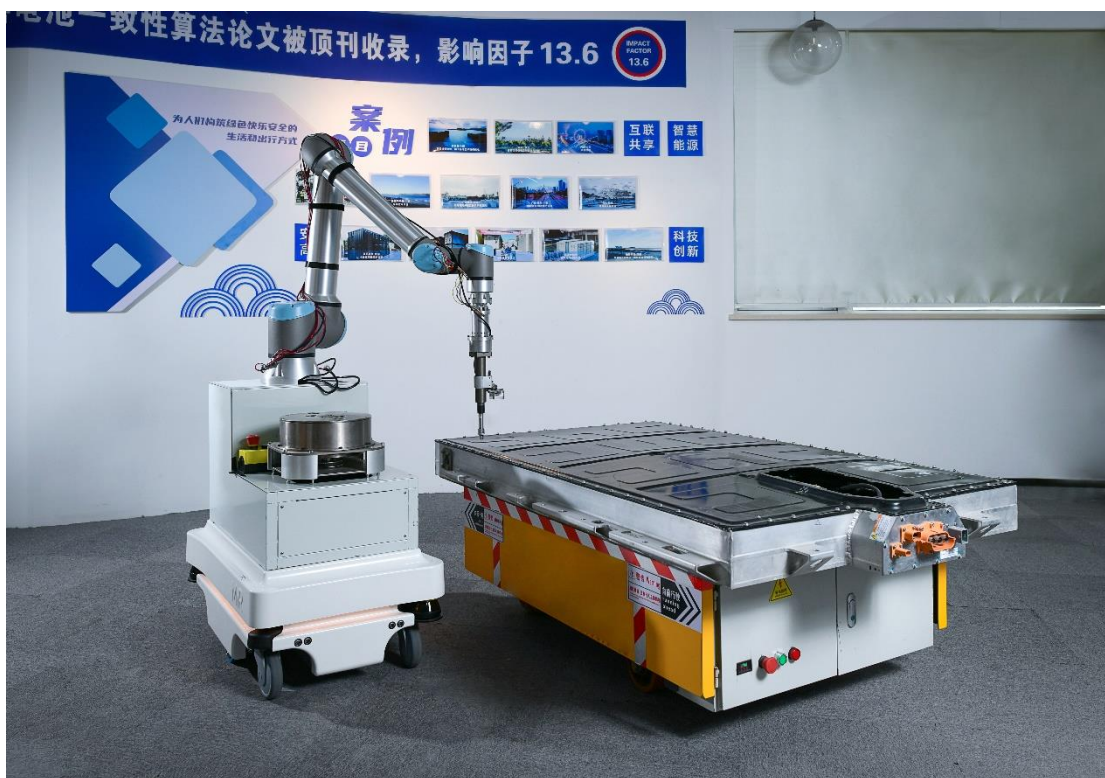
图 1：BEAM-1 自主拆解移动操作机器人
