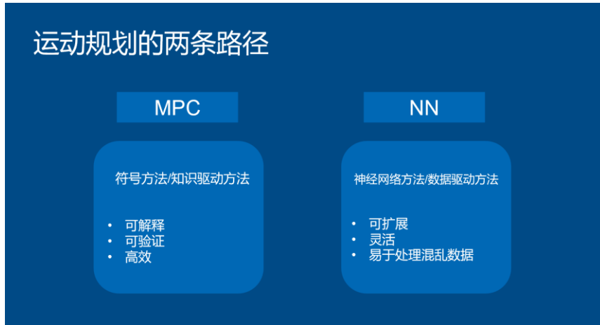
图 9 机器人运动规划途径：基于模型的方法（MPC）和基于学习的方法（NN）。
